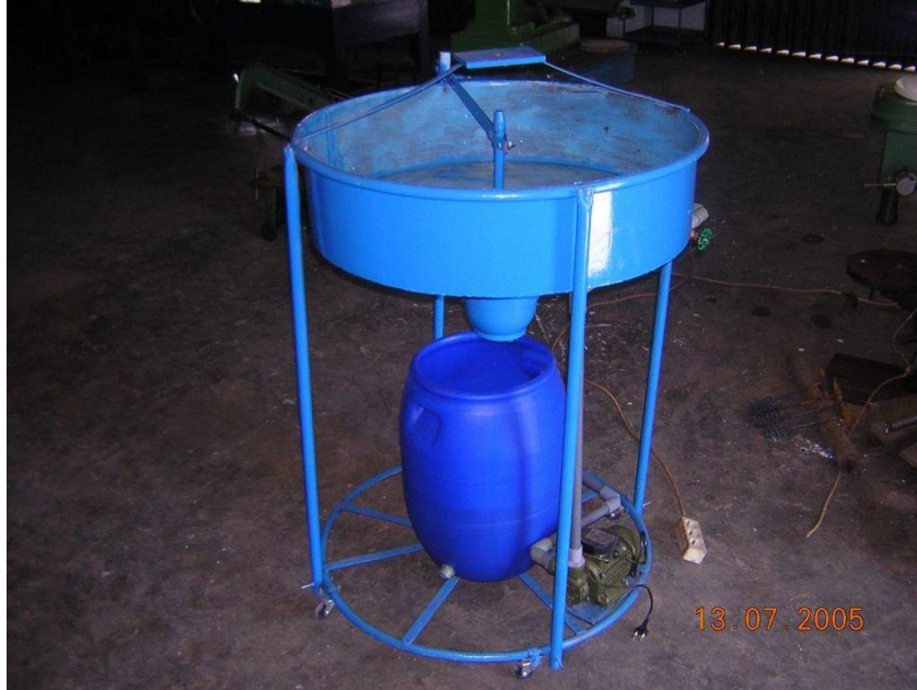
Gambar 7.1 : Alat Jominy Test
